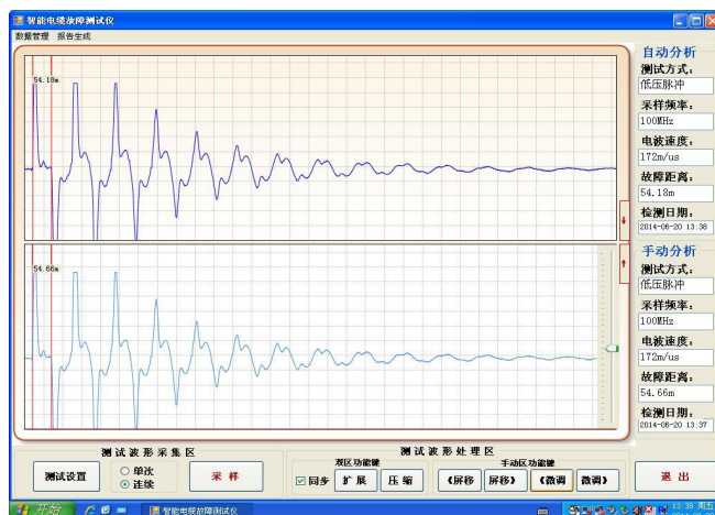
低压脉冲法测得短路故障或低阻故障波形
